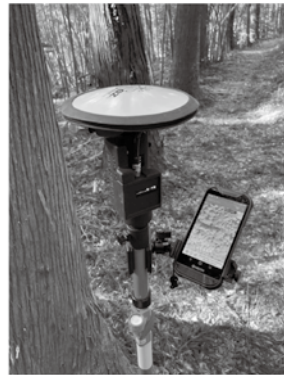
図3 モバイル端末を搭載したGNSS測量機器 （資料：株式会社バスコ「SmartSOKURYO POLE」）
