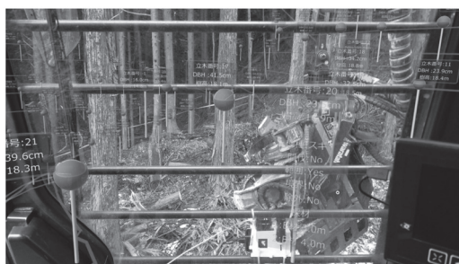
図4 AR技術により、スマートグラス上に表示された立木情報 (資料：株式会社アドイン研究所「OWL-ARナビゲーションシステム」)
