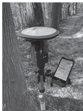
図3 モバイル端末を搭載したGNSS測量機器
