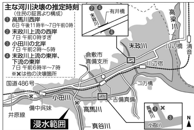
図3 小田川の破堤氾濫状況／出典：山陽新聞 2018年7月27日 ※) 末政川下流東岸④の越流氾濫は、筆者の聞き込みでは7日午前0時ごろ
